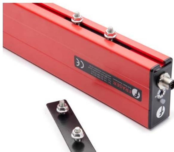
两端用 2 x 40 mm 滑块和 M6 螺栓固定，每增加 500mm 增加一个固定滑块。
